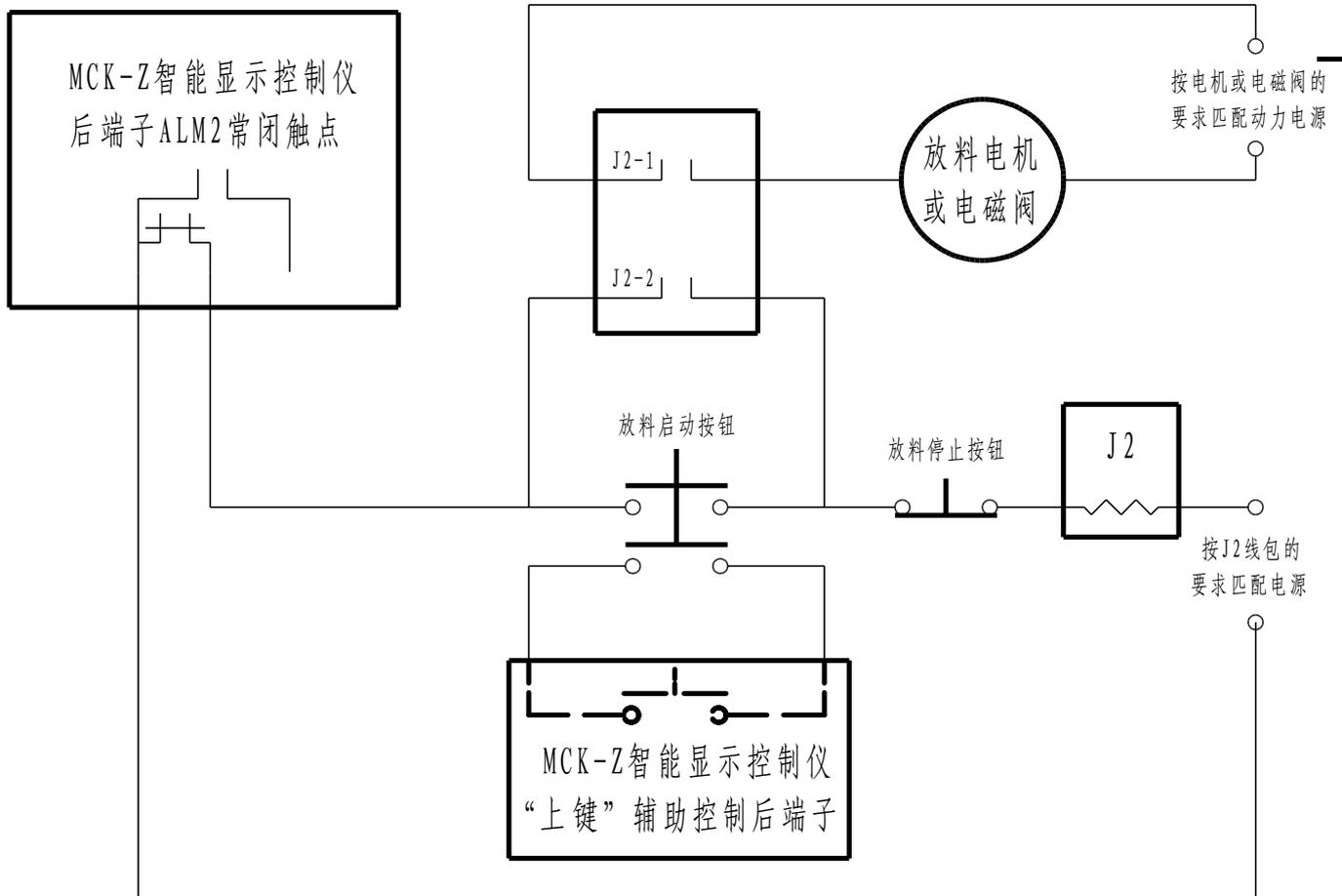
注：若仪表内部的ALM1与ALM2继电器触点功率参数超载，请用中间继电器扩容后再接入J1、J2回路！
